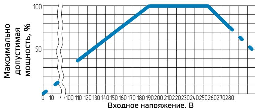
Как видно из графика – при существенных отклонениях входного напряжения от номинала, нагрузочная способность снижается.
